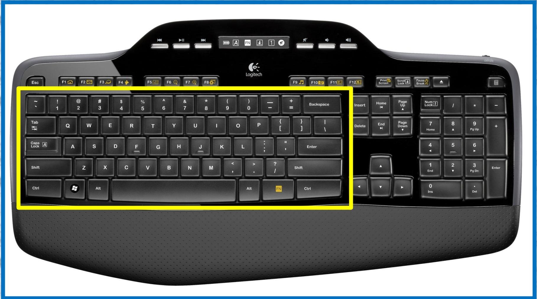
Alphanumerischer Tastenblock mit Buchstaben, Ziffern, Sonderzeichen und Steuerzeichen zur Eingabe von Daten, Text und Programmsteuerung
