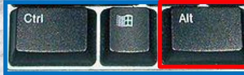
Sie ähnelt in ihrer Funktion der Umschalttaste beziehungsweise Hochstelltaste (englisch Shift) und ermöglicht neben dieser und der Strg-Taste eine vierte Ebene der Tastaturbelegung.
