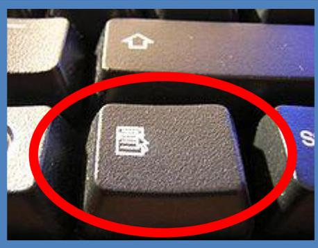
Die **Menü-Taste** auf einer Computertastatur dient zum Aufruf des sogenannten Kontextmenüs, das eine zur Cursorposition relevante Funktionsauswahl enthält.
