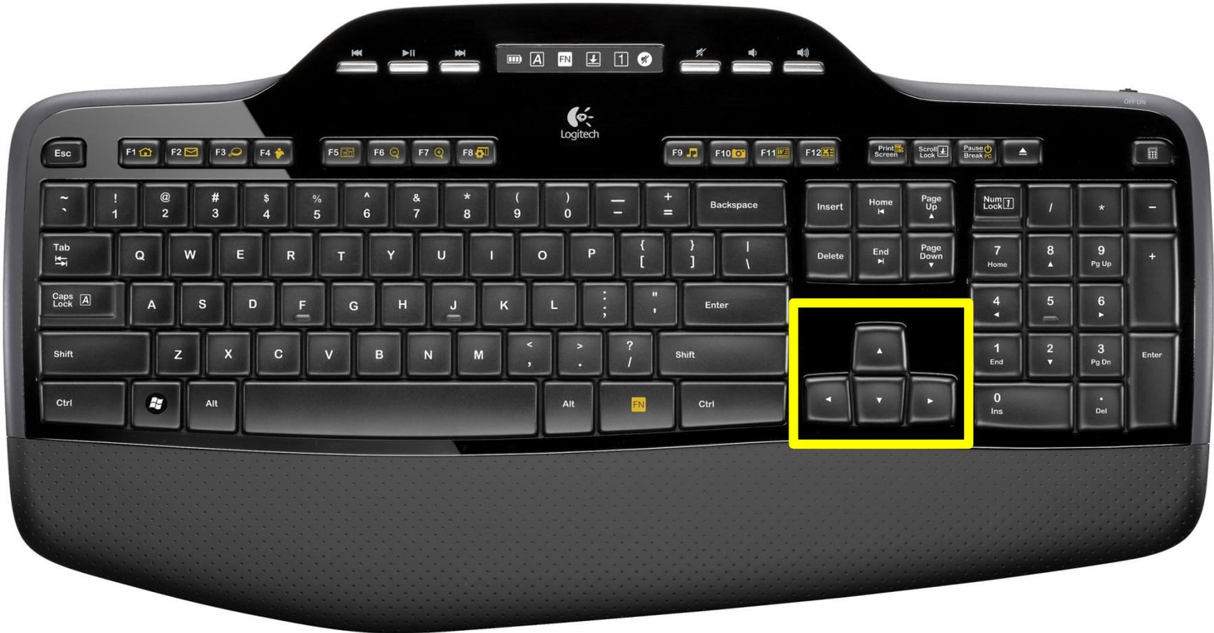
Separater Cursor-Tastenblock zur Steuerung
